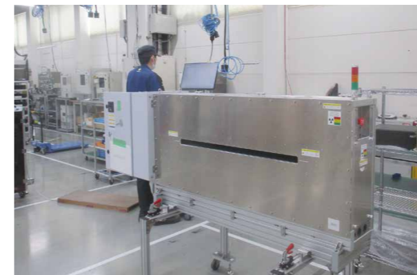
B 放射線源規制に対応したオンライン厚さ計生産ライン
