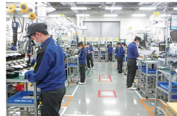
B 受注台数のばらつきを平準化し、ICT活用によるタクトタイム生産を行う組立ライン
