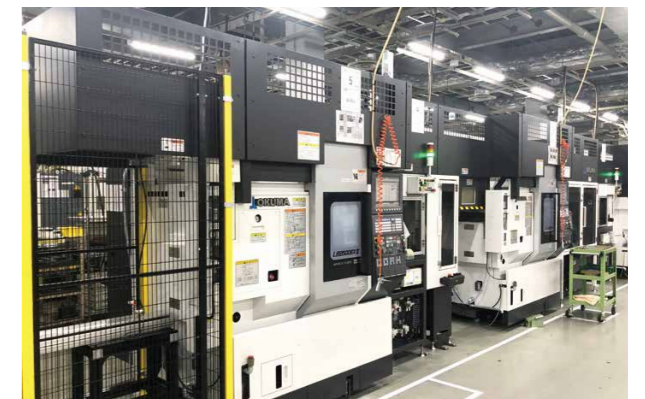
C 省人化と省エネを同時に実現した機械加工自動化ライン
